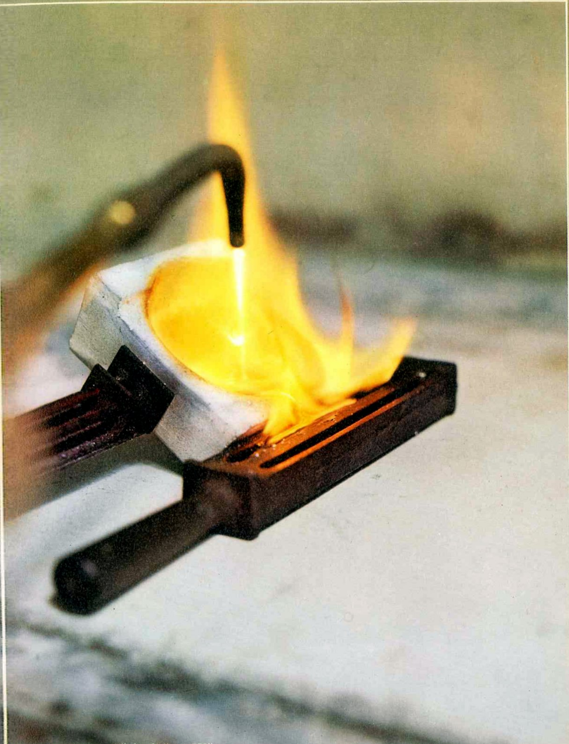
Foto 42. Moldagem em rilheira de "ouro 750"
