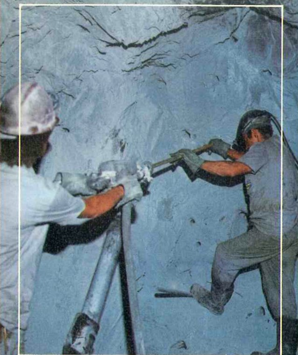
Foto 29. Perfuração na rocha para colocação de carga - Morro Velho
