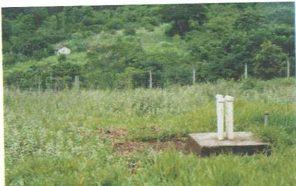
Foto 24 - Piezômetro multinível no córrego da Mata.
