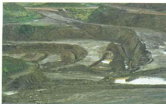
Foto 10 - Mineração de fosfato da Arafétil. Observar sistemas de drenos para rebaixamento do freático.
